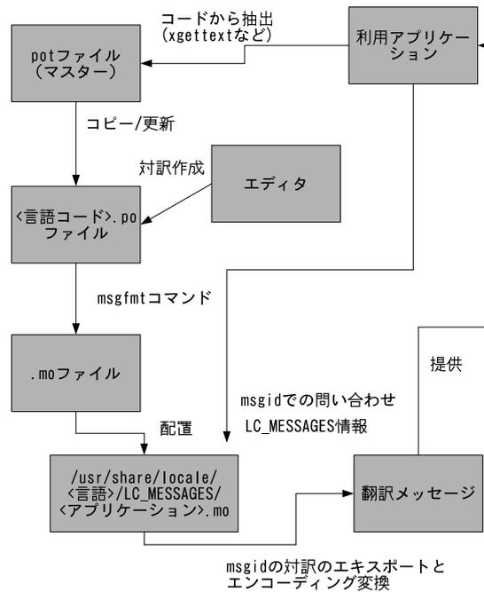
図2 GNU gettext の仕組みの概略
